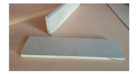
**Plataforma:** (tabla de DM de 400 mm por 100 mm, y 16 mm de ancho)
